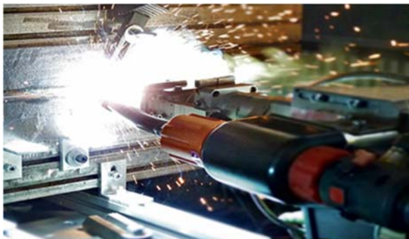
Bild 1: P 822 Einsatz des Laserstrahl-MSG-Hybridschweißverfahrens an längsgeschweißten Großrohren der Güte API-X80/ -X100 zur Steigerung der Zähigkeit und Erhöhung der Wirtschaftlichkeit
