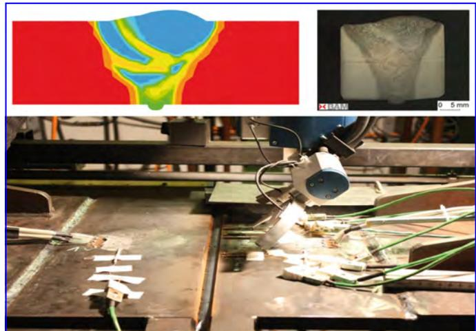
Spannungsbildung, so dass eine überschlägige Abschätzung des gesamten Verformungs- und Spannungszustandes auch für Experten in der Regel nicht mehr möglich ist. Die vorherrschenden Verformungen und Spannungen bestimmen jedoch maßgeblich die Eigenbeanspruchung der Schweißkonstruktion und damit deren Belastbarkeit im Betrieb. Eine genaue Kenntnis dieser Daten würde wertvolle Informationen zur Qualitätsoptimierung des Endproduktes liefern.
