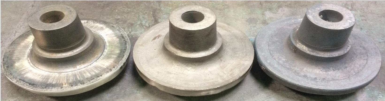
Darstellung der Stahl-Aluminium (links), Stahl-Stahl-(rechts) und Monoradnabe (Mitte)
