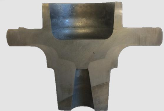
Stahl-Stahl Radnabe (Halbschnitt)
