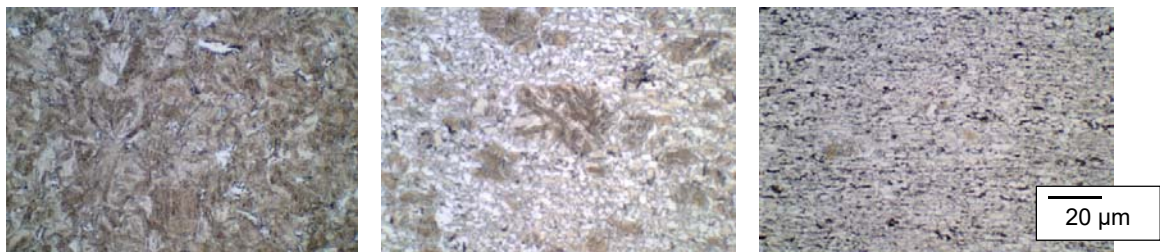
Abbildung 3: Schliffbilder aus dem Schichtstauchversuch nach der Wärmebehandlung; Links: nicht umgeformte Referenzprobe; Mitte: Umformung mit \varphi = 0,2 ; Rechts: Umformung mit \varphi = 0,4 (1000-fache Vergrößerung)
