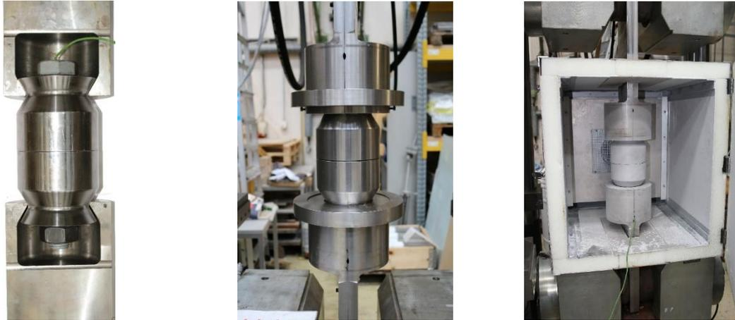
Bild 6 Versuchsaufbau für Bauteilversuche an Schraubengarnituren M36 bei tiefen Temperaturen
