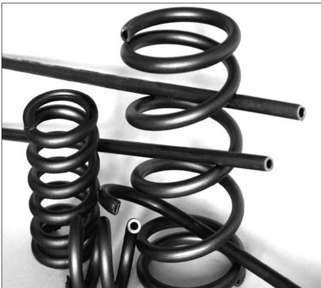
tung auf Anlasstemperaturen zwischen 350 und 500°C eingegrenzt. Es wurde festgelegt, das Rohr im weichen Zustand zur Feder zu formen und danach auf die gewünschte Festigkeit zu vergüten.
