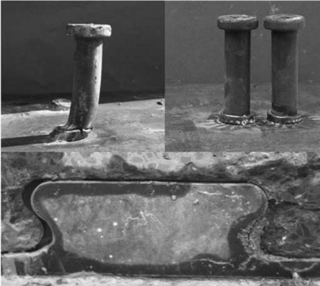
Schwerpunkt der Forschungsarbeit sowie die Übertragung der Ergebnisse aus den Abscherversuchen auf Verbundträger dar. Hierzu wurden Einfeldträgerversuche mit teilweisem Verbund unter statischer und zyklischer Beanspruchung durchgeführt und beschrieben.
