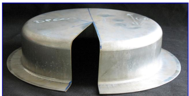
mittlung der Rückfederungsneigung ist die Betrachtung geometrischer Formabweichungen an Hutprofilen. Hierbei federt das tiefgezogene Bauteil nach der Entnahme aus der Form auf, da eine Freisetzung von Spannungen im Werkstoff erfolgt. Die geometri-
